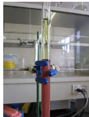
ガラスカラム下部が柿渋ゲル、上部に6価クロム溶液(黄色)を流すと、カラムの下部から6価クロムの除去された無色の溶液が流出してくる
